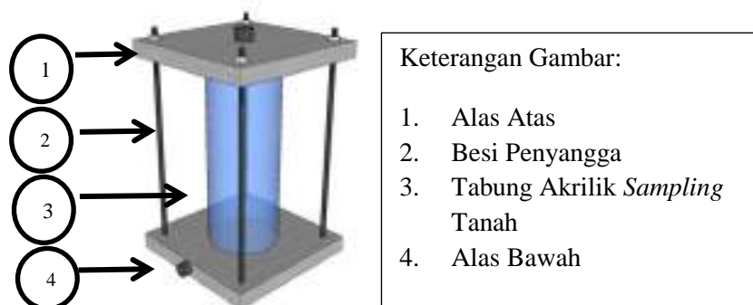
Gambar 3.9 Komponen Tempat Sampel Tanah
