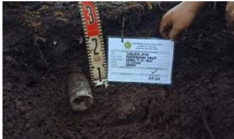
Gambar 3.7 Pengambilan Sampel Tanah Arah Horizontal
