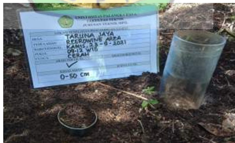
Gambar 3.6 Contoh Pengambilan Sampel Arah Vertikal
